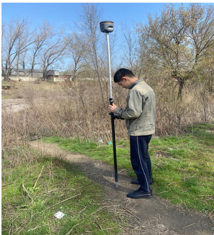
3 - сурет – Жобадан жер бетіне шығару 3 Талғар ауданында жерге орналастыру жобасын геодезиялық қамтамасыздандыру
